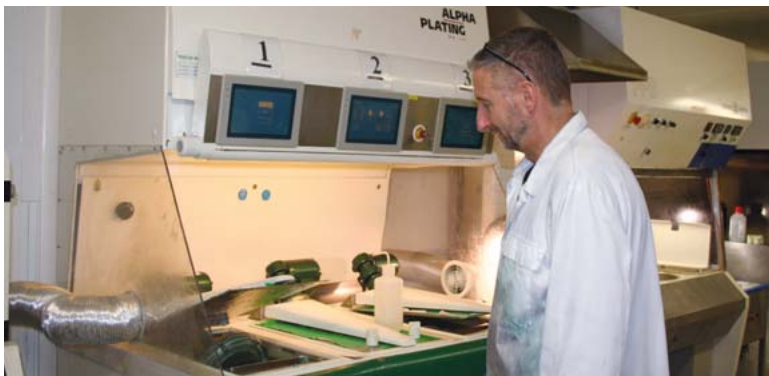
Media Industry intègre dans son usine sa propre galvanoplastie qui lui permet de fabriquer en interne les matrices dites stampers en vue du pressage. Chaque matrice permet de presser en moyenne 1 000 vinyles avant d'être remplacée. L'usine dispose désormais de 4 bacs de galvanoplastie.
